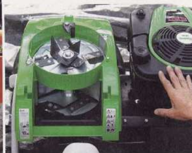
Changement de grille sur l'Eilet Maestro (à gauche). Deux chambres de broyage sur le gros Viking GB 460 (ci-dessus).
